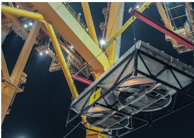
8 Intercambiadores de Calor enviados desde Jebel Ali hasta África Occidental usando una grúa Gantry.
